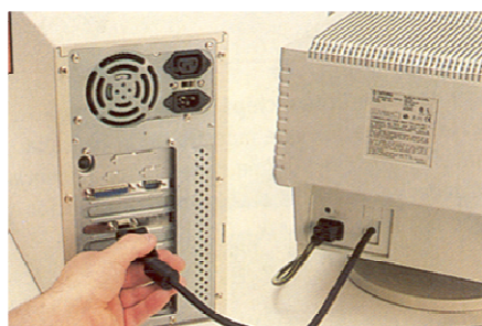
c) Conectar el cable de video al gabinete
