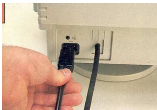
c) Conectar el cable de video al gabinete
